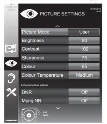
Select the line »Picture Mode«, »Brightness«, »Contrast«, »Sharpness«, »Colour«, or »Colour Temperature« with »V« or »A«. Select the value with »<« or »>« and press »OK« to confirm.
